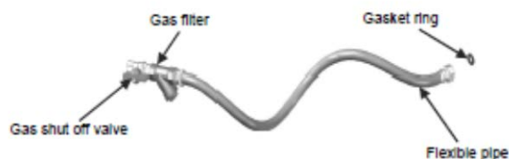
Схема 12: Подключване с гъвкава връзка (опция, може да се закупи от производителя)
