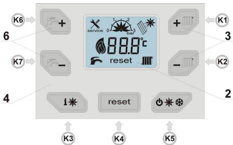
Схема.2.2.1.2. Елементи в едноконтурния котел ECOCONDENS SLIM
