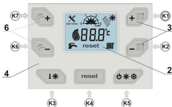
Схема 2.2.1.2. Елементи в едноконтурния котел ECOCONDENS CRYSTAL PLUS 50 Управление на котела
