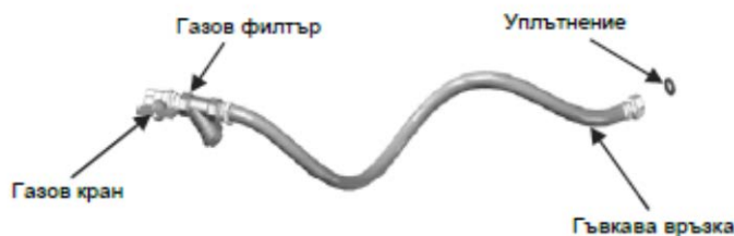
Схема 4. Свързване с гъвкава връзка (опция, може да се купи от производителя на уреда)
