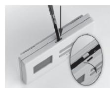
Батериите се намират в предната част на корпуса. Поставете **2 броя алкални батерии тип LR6**, с показаната ориентация на полюсите. След поставяне на батерийте на дисплея се показва измерената вътрешна температура според заводската настройка. Ако не се показват тези индикации, трябва да се натисне бутона „**RESET**”, който се намира под капака на уреда на основния панел за управление.
