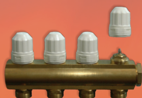
MF01 (3-8 разклонения) 1"-ов колектор с вграден регулируем клапан (размери за присъединяване на регулиращи компоненти: M30 x 1,5 mm)
